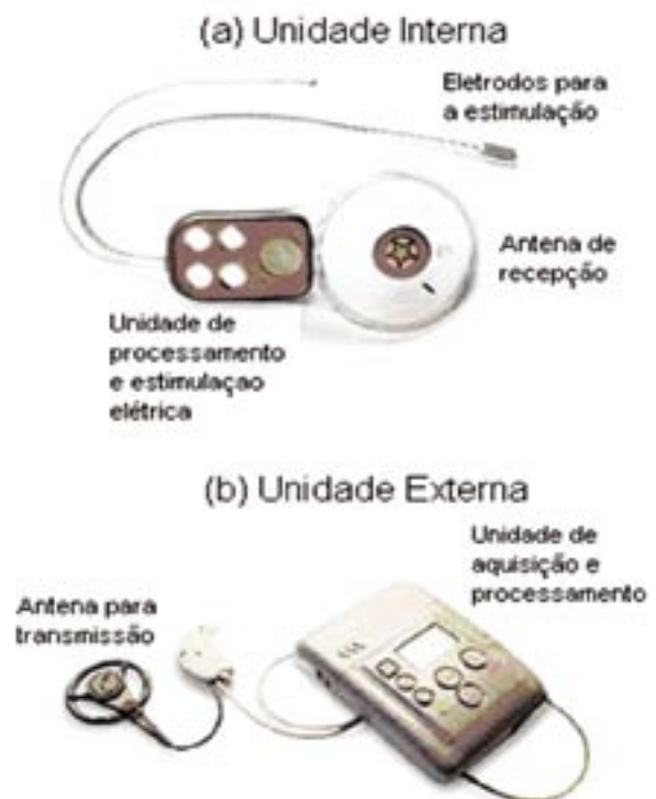
Figura 20: Sistema completo para implante do tronco cerebral. Em (a) unidade implantável do sistema, responsável pela recepção, processamento e estimulação elétrica por
