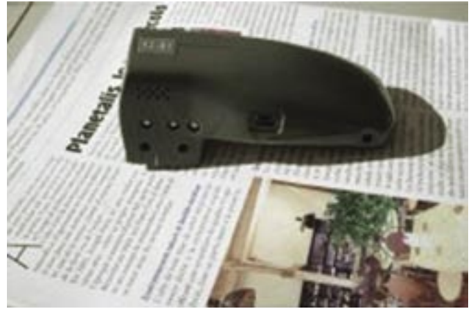
Figura 10: Top Braille – dispositivo que converte textos em caracteres Braille ou em voz (adaptado de TopBraille, disponível em www.top-braille.com , acessado em 28/04/2008).
